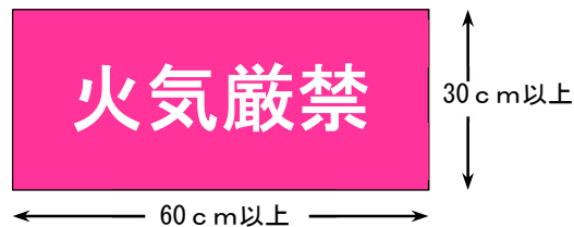
【第2-5図 可燃性液体類等の掲示板の例】
