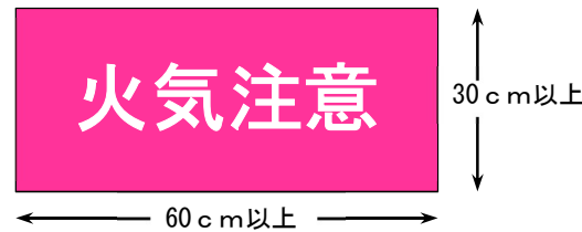
【第3-6図 第2類の危険物（引火性固体を除く。）の掲示板の例】
