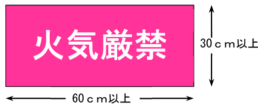
【第3-7図 第4類の危険物等の掲示板の例】
