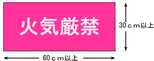
【第2-5図 可燃性液体類等の掲示板の例】
