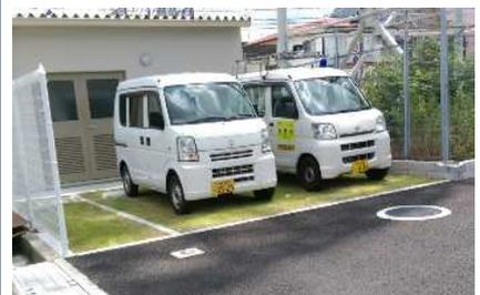
駐車場に芝生ブロックを配置し緑地を確保することで、雨水を地中に浸透させる施設
