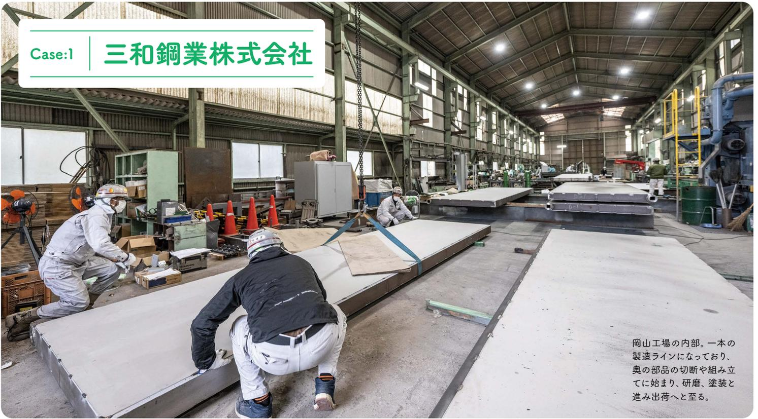
岡山工場の内部。一本の製造ラインになっており、奥の部品の切断や組み立てに始まり、研磨、塗装と進み出荷へと至る。
