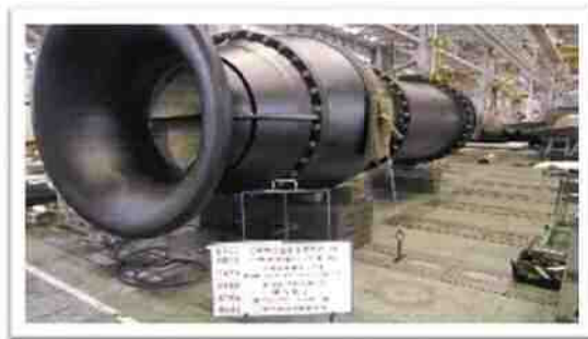
【雨水ポンプ設備の整備後】
