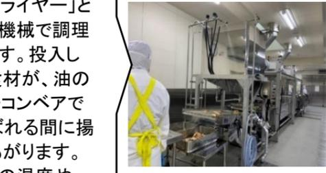
揚物は、「連続フライヤー」という機械で調理します。投入した食材が、油の中をコンベアで運ばれる間に揚げあがります。
