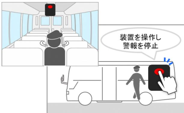
車内を確認し、運転者等が車両後部の装置を操作すると**警報が停止**
