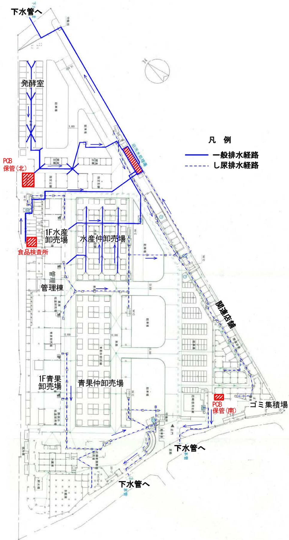
図3-1-4 排水経路図(現在:下水放流)
