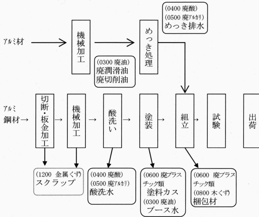
図 3. 電力用開閉装置製造フローシート(溶接品の場合)
