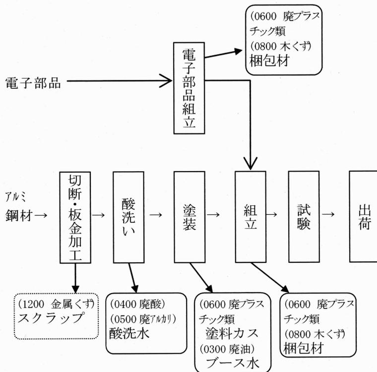
図2. 車両用推進制御装置製造フローシート
