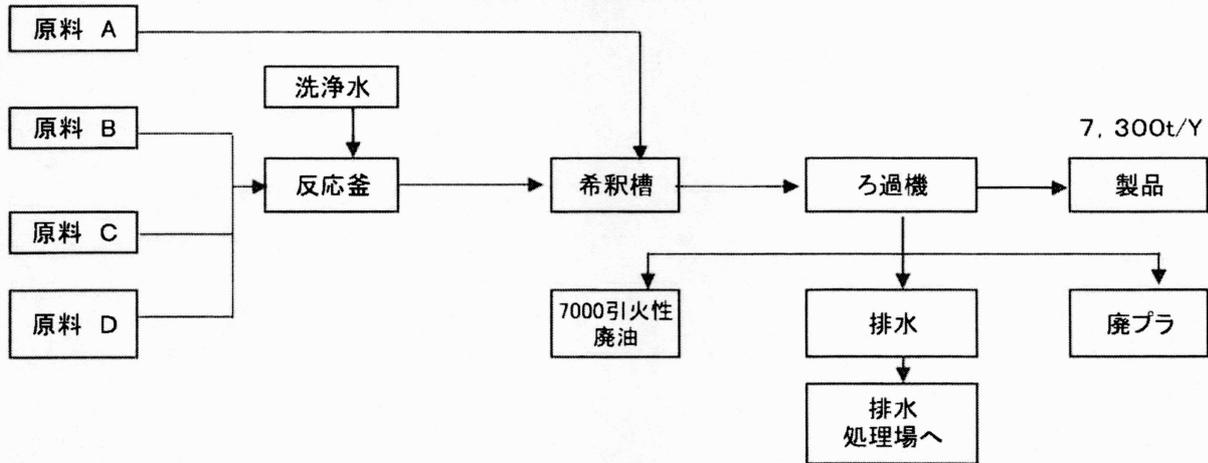
図一2 塗料製造フローシート(溶剤系)
