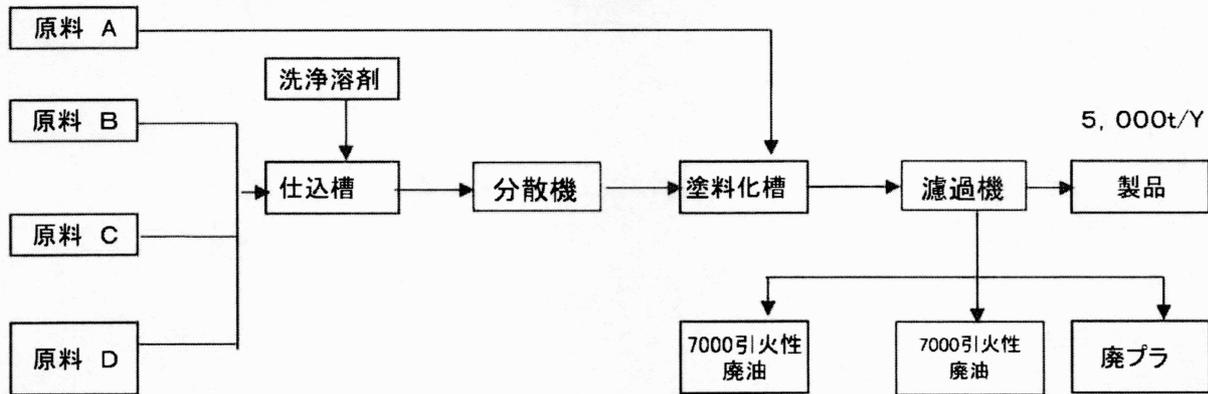
図一3 塗料製造フローシート(水系)
