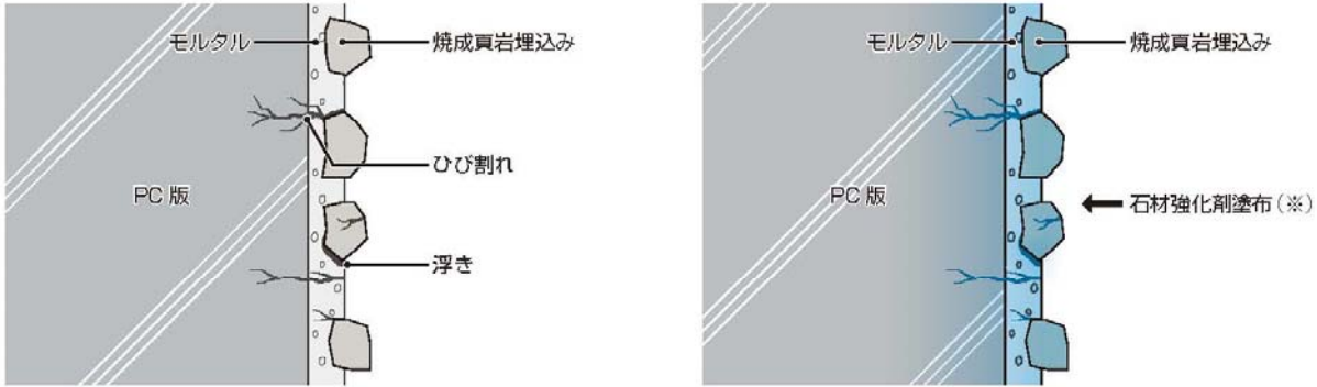
焼成頁岩剥離防止のメカニズム
