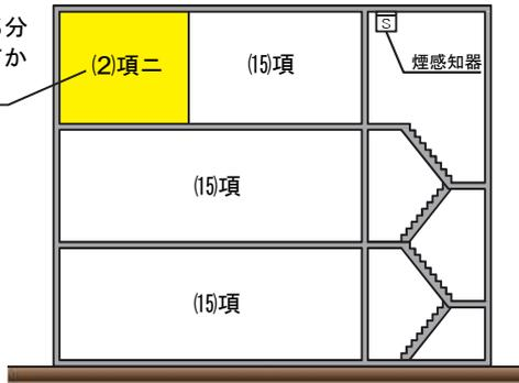
省令第23条第4項第7号への規定より、階段及び傾斜路に煙感知器を垂直距離15m（3種の感知器にあっては10m）につき1個以上設ける。
