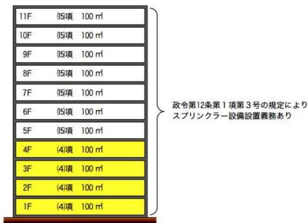
スプリンクラー設備の非常電源は、自家発電設備、蓄電池設備又は燃料電池設備によるものとしなければならない。
